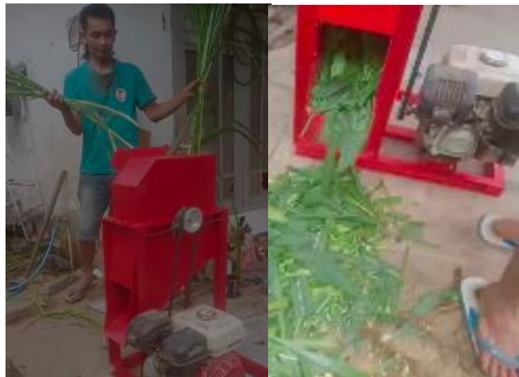
Gambar 4 Penerapan teknologi tepat guna mesin pencacah rumput
